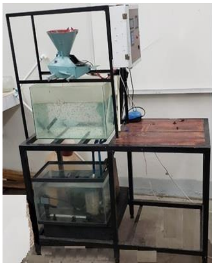
Figura 9. Sistema Automatizado para el hormonado de alevines de tilapia.
