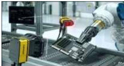
Figura 9. Ejemplo de un sistema de inspección visual artificial de modo automático.
