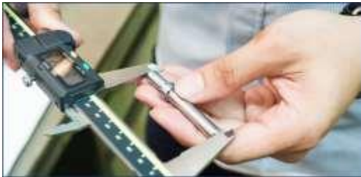
Figura 2. Inspección de una pieza con vernier digital.
