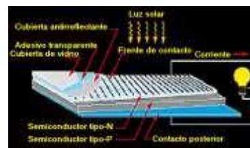
Figura 1. Partes que conforman una celda fotovoltaica [8]
