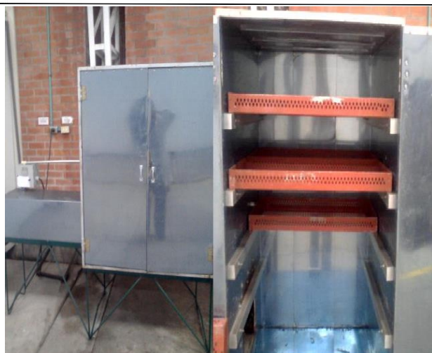
Imagen 2. Horno artesanal deshidratador.
