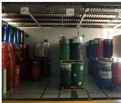
Figura 13. Distribución de los tambos de sólidos contaminados.
