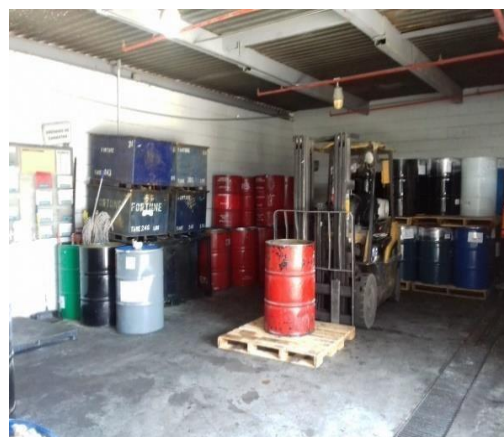
Figura 2. Almacén sin delimitación de áreas.
