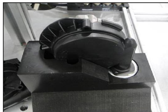
Figura 16. Fixtura para Atornillado.
