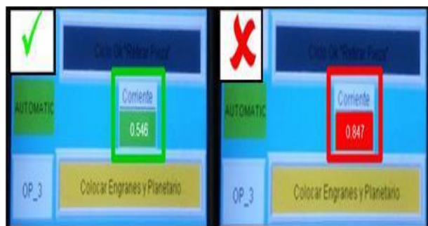
Figura 18. Izquierda: Motor con Corriente Aceptable. Derecha: Motor con Corriente Alta.
