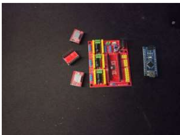
Figura 15. Vista superior de la tarjeta de control para motores y de la placa Arduino NANO.
