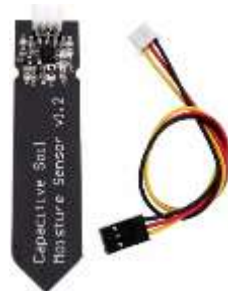
Figura 3. Sensor de humedad de suelo.
