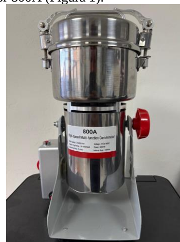
Figura 1. Molino para la reducción del tamaño de las fibras de bagazo.
