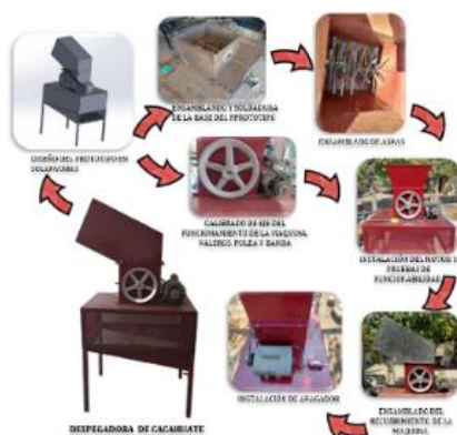
Figura 7. Esquema representativo de la manufactura del prototipo de la máquina despegadora de cacahuate.
