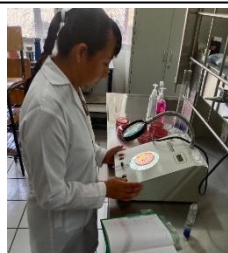
Figura 10. Conteo de la UFC con el contador de colonias, Felisa.
