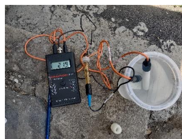
Figura 1. Medición de TDS, g/L Temperatura °C y pH. Fuente: Elaboración propia.
