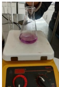
Figura 2. Muestra con el indicador eriocromo negro T. Fuente: Elaboración propia.
