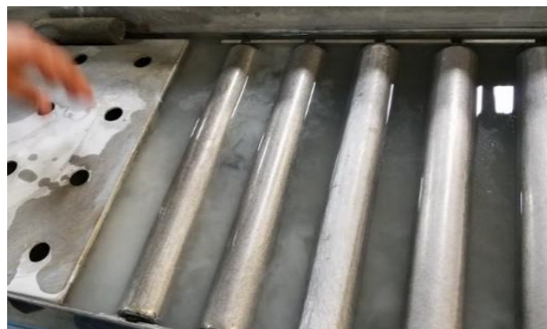
Figura 14. Limpieza de transportador para modelos compactos.
