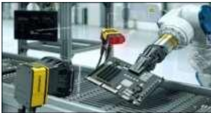
Figura 9. Ejemplo de un sistema de inspección visual artificial de modo automático.
