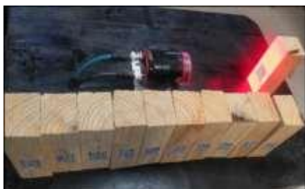
Figura 20. Inspección de pieza por pieza a través del sensor de visión serie IV/IV-H.
